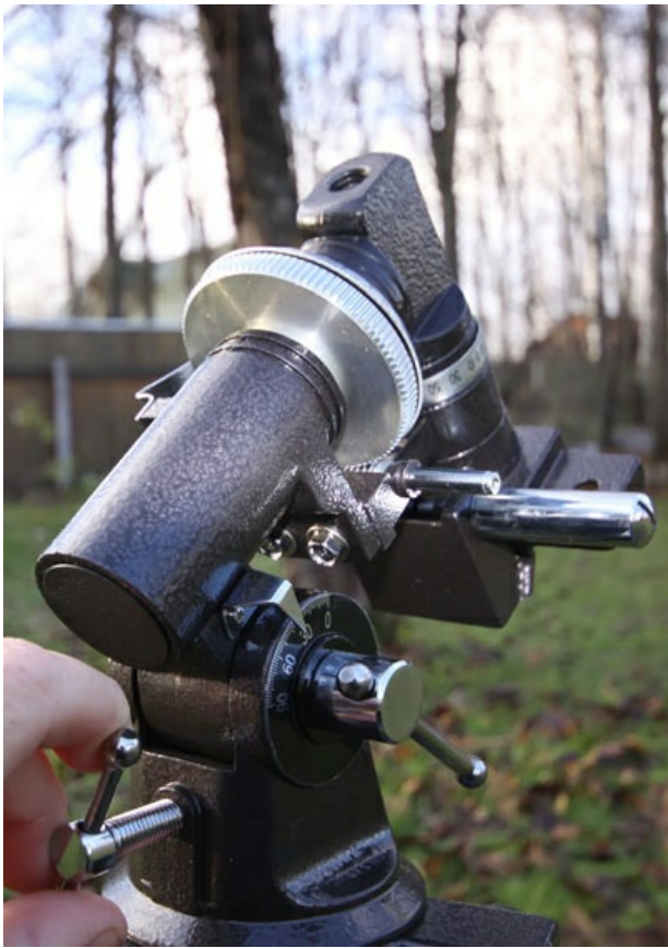
Вворачиваем шлангу противовеса и устанавливаем груз на ее ось. Ставим страховочный винт, чтобы противовес не упал нам на ногу.
