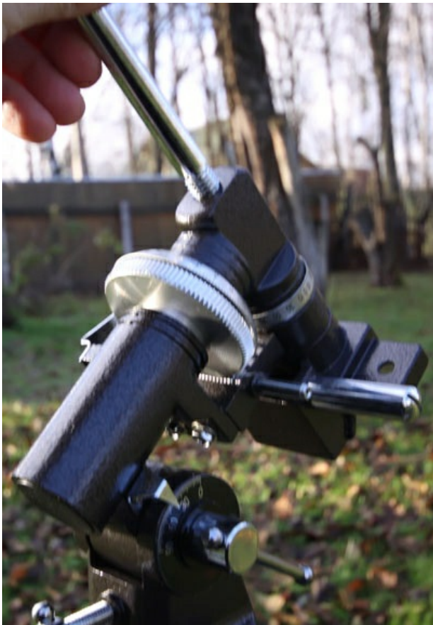
Вворачиваем шлангу противовеса и устанавливаем груз на ее ось. Ставим страховочный винт, чтобы противовес не упал нам на ногу.
